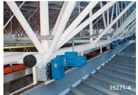
Der stirnseitig angegossene Drehmomentzahnkranz am Getriebedeckelgehäuse unserer Flachgetriebe erlaubt es, in Kombination mit der dazugehörigen Drehmomentstütze, den Antrieb in verschiedenen Positionen an den Radblock DRS zu fixieren – in 15°-Schritten, so wie der Antrieb am besten in die Anschlusskonstruktion hinein passt.
