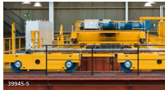
Die Verwendung dieser bewährten Serienbauteile bietet hohe Funktionssicherheit und gewährleistet die Austauschbarkeit beim Wechsel des Rades. Aufgrund ihrer
