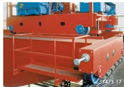
Die Radsätze können sowohl in Hohlprofile und Kasten-träger eingebaut als auch als Ecklagerung ausgeführt werden. Die Ecklagerung bietet den Vorteil, dass der komplettierte Radsatz ohne aufwändiges Ausrichten in den Fahrwerksträger montiert werden kann. Der schnelle Wechsel der Einheit ohne notwendige Ausrichtarbeiten gewährleistet eine hohe Verfügbarkeit der Anlage.
