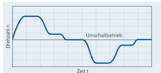
Im Umrichterbetrieb kann die für Fahrmanöver optimierte Kennlinie passend verschoben werden
